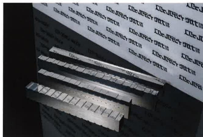
各種溝槽加工・成形加工
